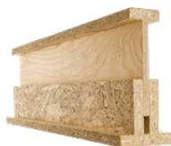
Die Bodentasche BT 85/9 besteht aus einem 10 cm breiten OSB-Streifen, in welchen senkrecht zwei OSB-Streifen (Höhe 85 mm, Stärke 18 mm) eingenetzt sind.
